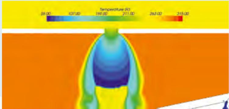
**EXPLOSION.** Temperaturverteilung in Gasleck mit Überschallströmung.
