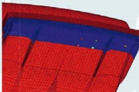
**Hinterschiff einer Megayacht.** Ursprüngliches Design (links) und modifiziertes Design mit um fast 30 Prozent reduzierten Slammingdrücken.
