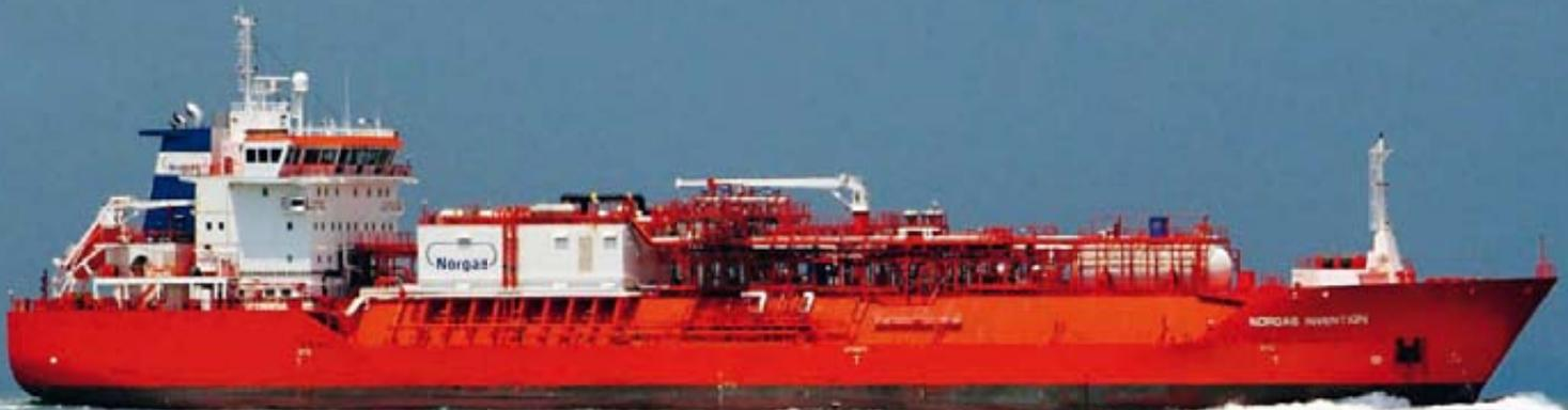
„NORGAS INVENTION“. Kurzstrecken-LNG-Tanker mit GL-Klasse.
