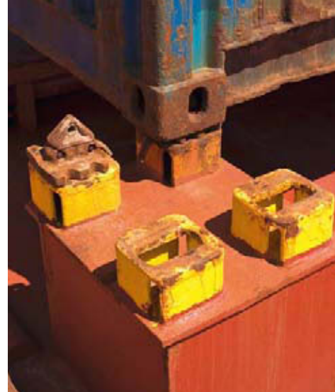
CONTAINERECKBESCHLAG. Korrosion und Abnutzung im Betrieb.
