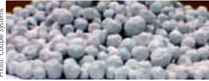
GRANULAT. Die gelöschten Kalkkugeln binden den umweltbelastenden Schwefel.
