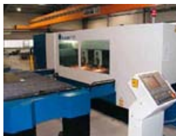
FERTIGUNG. Hochmoderne Doppelkopf-Laserschneidanlage für Elektrobleche.
