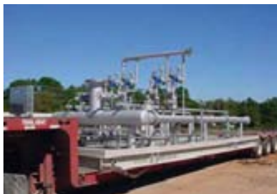
LANDWEG. Komplettete Anlagenteile werden mit speziellen Tiefladern transportiert.
