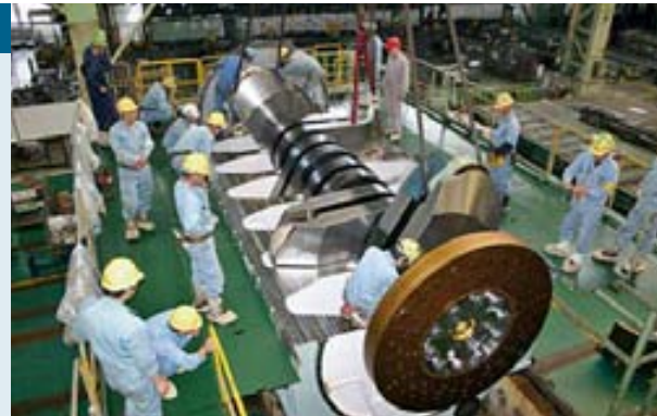
PRODUKTION. Kurbelwelle eines Zweitaktmotors mit Schwingungsdämpfer von Geislinger.
