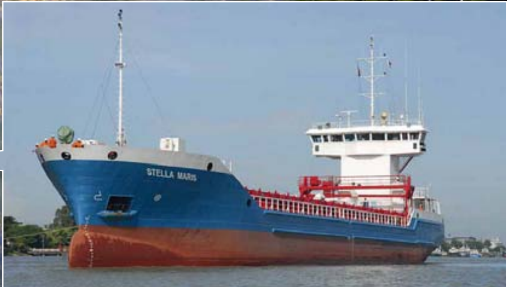
EXPORTMODELL. Die „Stella Maris“ entstand auf der Ananda-Werft in Meghnaghat. Die Daten: Länge über alles: 81,35 m; Breite auf Spanten: 13,15 m; Seitenhöhe: 6,20 m; Hauptmaschine: MAN B&W 8L21/31 mit 1720 kW; Verstellpropeller. Klassenzusatz: Rumpf: + 100 A 5 E mit Freibord 1,560 m; SOLAS II-2 Reg 19 DBC; Mehrzweck-Trockenfrachtschiff; ausgerüstet für Containertransport; Verstärkt für Schwerlasten. Maschinen: + MC E AUT-16h
