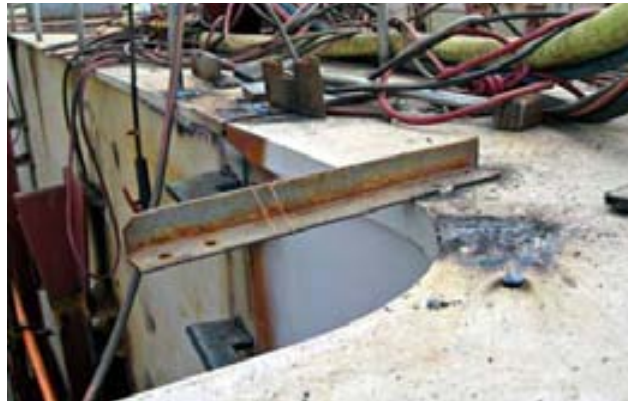
LUKENECKE. In diesem hochbeanspruchten Bereich ist Schweißen besonders kritisch.
