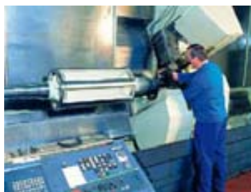
TECHNIK. Wellenbearbeitung von allen Seiten in einem Arbeitsschritt.
