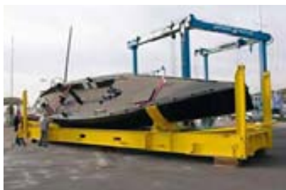
MASSARBEIT. Der offene 40-Fuß-Container wurde extra für den Transport der Einheitsklasse RC 44 entwickelt und gebaut.
