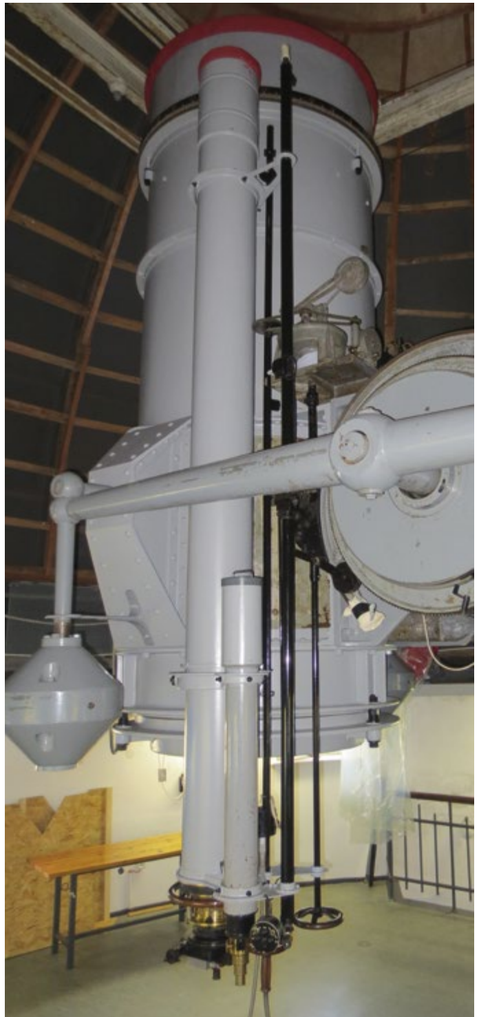
Das Spiegelteleskop nach der Restaurierung. Blick auf die beiden Leitrefraktoren vor dem großen Tubus, links ein kleines Ausgleichsgewicht der Entlastungsmontierung nach Franz Meyer. Foto: Alscher Restaurierung.
