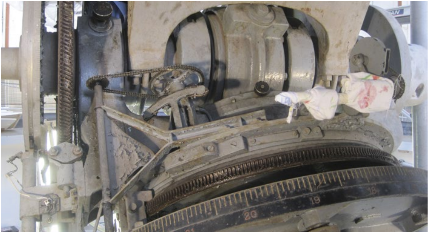
Doppellagerbock mit Stundenplatte vor der Restaurierung. Blick auf die verdrehte Stundenskala, auf das Schneckenrad für die Stundenbewegung mit verschmutzten und verharzten Schmierstoffen und stark abplatzender Beschichtung. Foto: Alscher Restaurierung.
