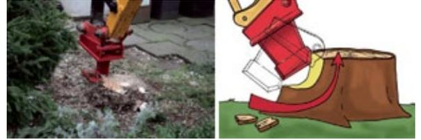
Hilfreicher Tipp aus der Rodungsanleitung: Wer mit der Löffelhydraulik arbeitet, hat es leicht. (Fotos: WURO-TEC GmbH & Co. KG)
