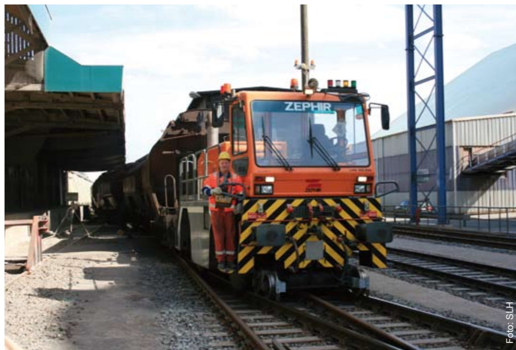
Eine eigene Zugmaschine zieht die Schüttgutwaggons am Kalikai in Position
