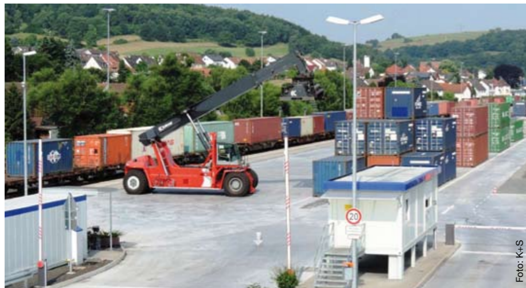
Ein Reachstacker hebt am Werra-Kombi-Terminal Container auf einen Shuttlezug
