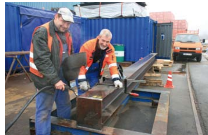
Gewusst wie: Mitarbeiter schweißen einen Stapelvorsatz
