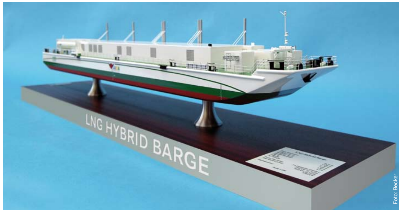
So soll die LNG-Barge der Hybrid Port Energy GmbH einmal aussehen: Sie hat keinen Antrieb und muss geschleppt werden
