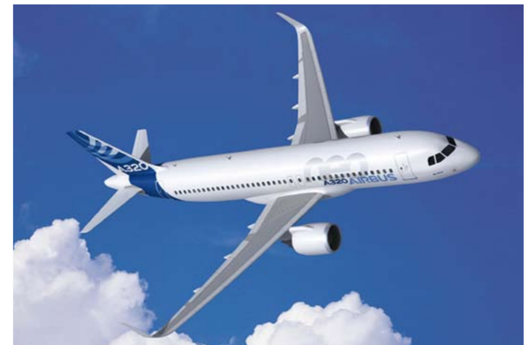
Die A320 neo verbraucht dank neuer Flügelspitzen und Triebwerke 15 Prozent weniger
