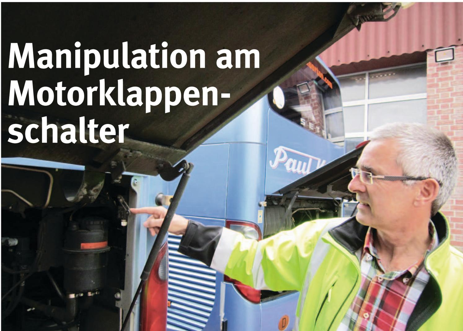
An Bussen gibt es zum Schutz der Mechaniker einen Schalter, der verhindert, dass der Motor gestartet wird, während die Motorklappe offen ist. Leider wird diese Schutzvorrichtung oft manipuliert – und das kann tödliche Folgen haben!
