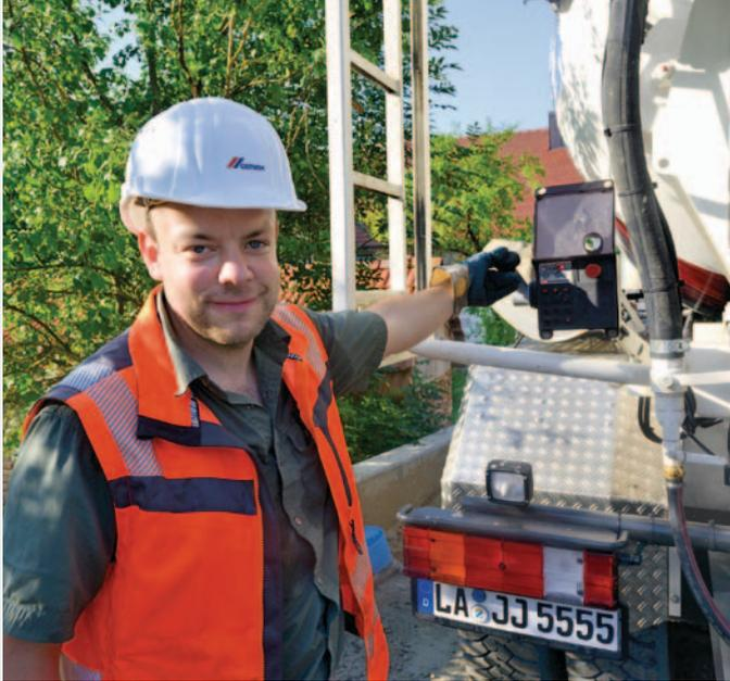
Unternehmer Sepp Frank demonstriert, wie sich die Fahrzeug-Trommel von einem Panel am Heck steuern lässt (oben). Die Zutaten für den Beton werden bei CEMEX erst Minuten vor dem Transport gemischt (unten).
