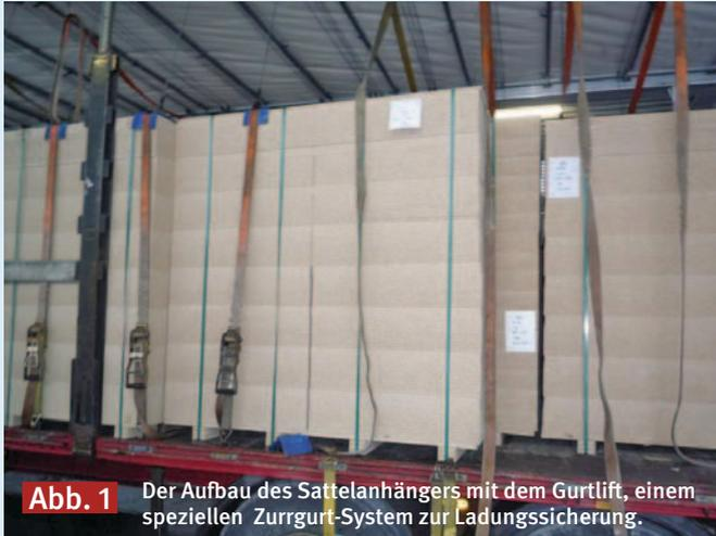
**Abb. 1** Der Aufbau des Sattelanhängers mit dem Gurtlift, einem speziellen Zurrort-System zur Ladungssicherung.
