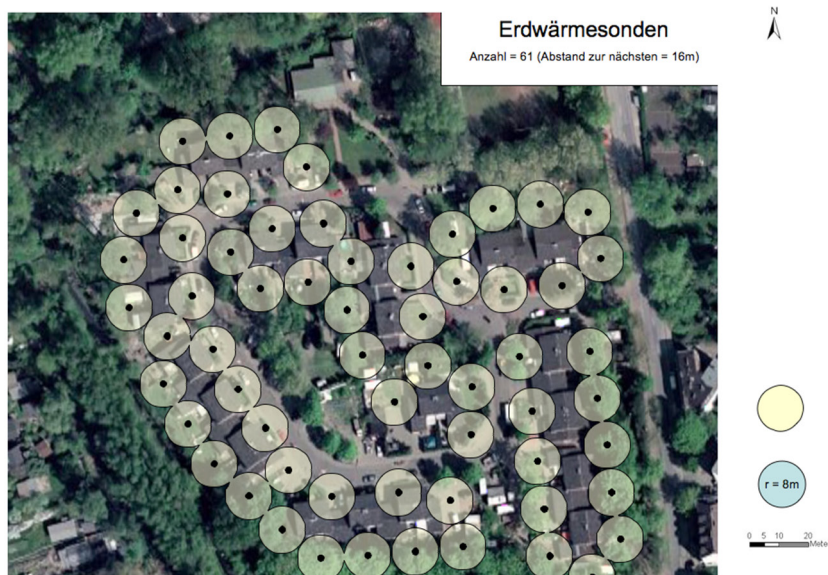
Abb. 27 Maximale Dichte vertikaler Erdwärmesonden bei einem thermischen Sicherheitsabstand von mindestens 16m. Die im Modellraum (für die Szenarien) angenommene Dichte entspricht der Hälfte der hier dargestellten Dichte.
