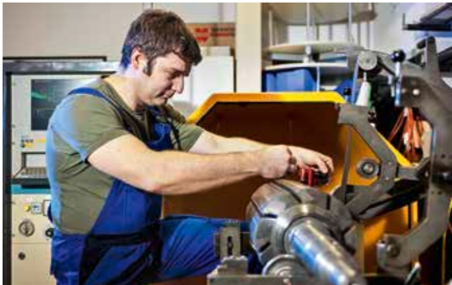
Auswuchten eines Hobelkopfes bei der ICA Industrial Control & Automation GmbH.
