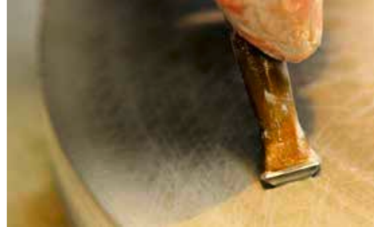
Edelsteine klebt Harald Albrecht auf ein Kitholz und bearbeitet sie mit einer diamantbesetzten Schleifscheibe.
