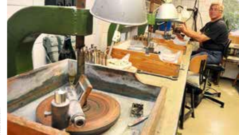
Harald Albrecht benötigt in seiner Brüsewitzer Werkstatt zahlreiche Schleifscheiben zum Abtragen und Polieren.
