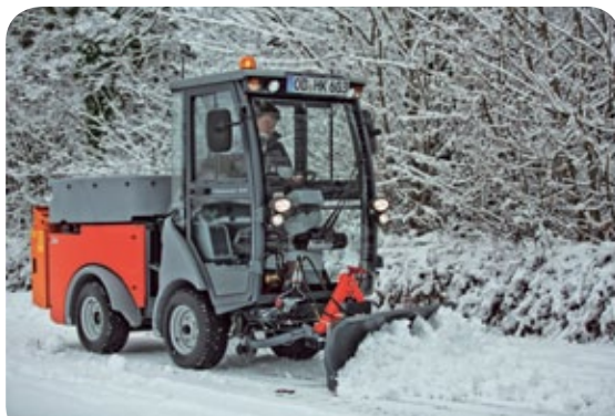
Der Citymaster 600 ist als ultrakompakter, knickgelenkter Geräteträger ein idealer Winterarbeiter. (Fotos: Hako GmbH)
