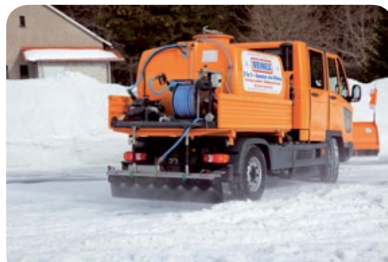
Der Multicar FUMO mit Doppelkabine und Solesprüher sorgt für eisfreie Straßen und Wege.
