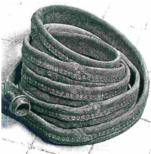
Die einzelnen Schläuche in Längen von 5 bis 8 m (eine Normlänge wie heute gab es natürlich noch nicht!) konnten mit Verschraubungen aneinander gekoppelt werden. Auch die Ausführung dieser „Kuppungen“ entsprach dem Augenmaß und Geschick des jeweiligen Handwerkers.
