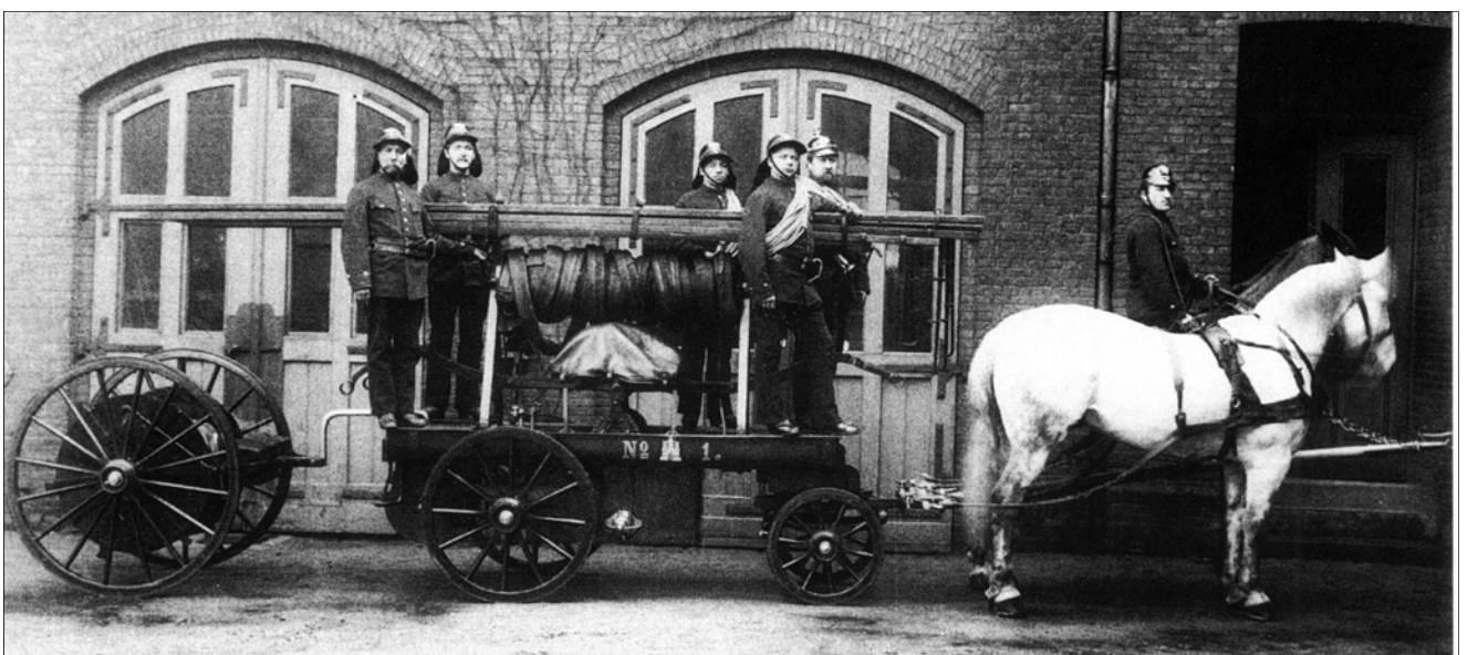
Handdruckspritze mit Schlauchhaspel No 1 der Berufsfeuerwehr von 1872.
