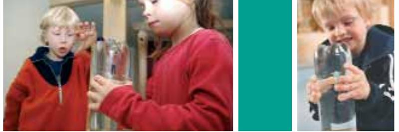
**Durchführung:** Eine Flasche wird vollständig mit Wasser gefüllt. Der Flaschentänzer wird in die Flasche getaucht. Nun wird die Flasche mit einem Gummistopfen verschlossen. Es sollte möglichst keine Luftblase mehr in der Flasche sein.
