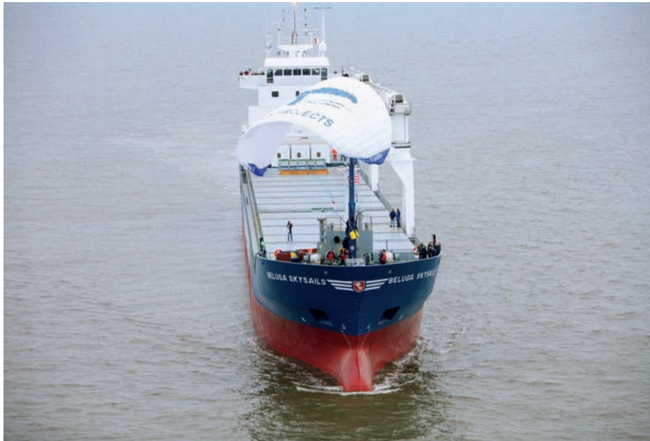
Das Frachtschiff „Beluga“ testet bereits seit längerem den SkySails-Antrieb. Dieses Jahr soll die SkySails-Serienproduktion beginnen
