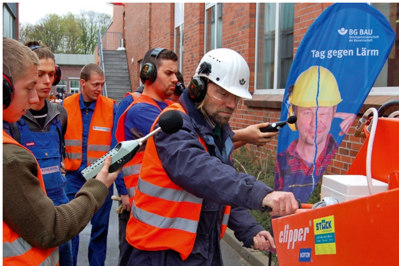
Die Messgeräte in der Hand: Lehrlinge des Ausbildungszentrums Bau in Hamburg an der Steinschneidemaschine. Bis zu 110 Dezibel verursacht diese Maschine.
