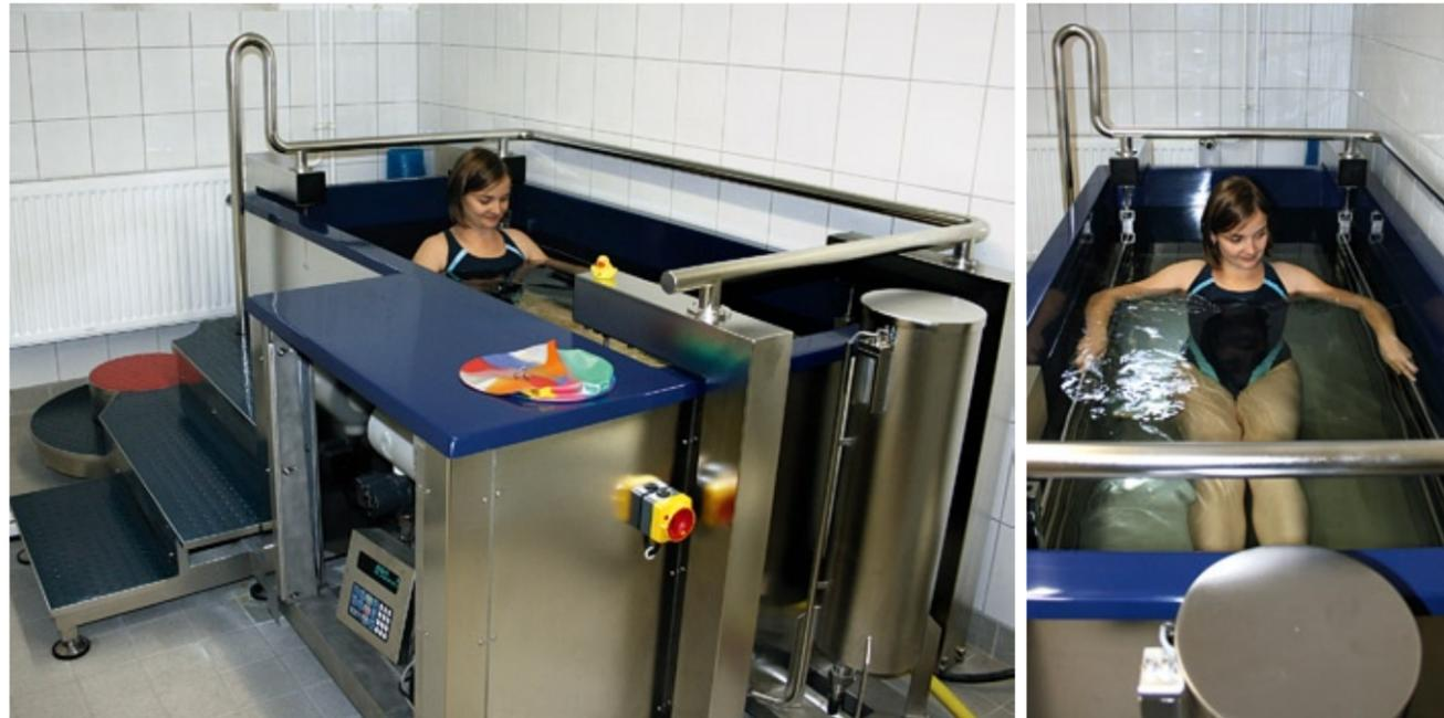
Diese von Borngässer entwickelte Unterwasserwaage wird an der Universität Kiel zur Diagnose und Erforschung von Adipositas eingesetzt. Die damit mögliche kombinierte Ermittlung des Körpergewichts, des Auftriebsgewichtes und des Körpervolumens in einer kompakten Anlage ist weltweit einzigartig.
