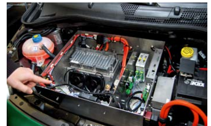
Moderner Blick unter die Kühlerhaube: In der Multibox befinden sich das Batteriemanagementsystem und die elektronische Motoransteuerung.
