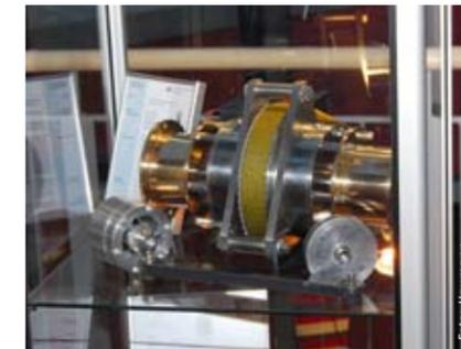
Ventilkolbenpumpe mit Hubkolbenvorrichtung von Elmer Schmidt aus Flintbek.
