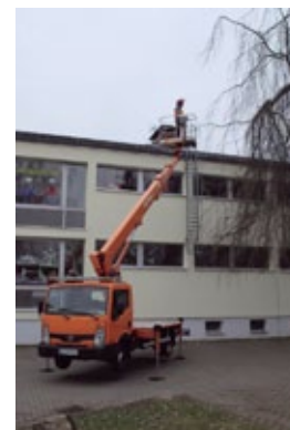
Die Lkw-Arbeitsbühne kann nah an den jeweiligen Arbeitsort herangefahren werden. Die Rüstzeiten sind gering, so dass die Baumpflegearbeiten schnell können. (Fotos: Kunze GmbH)
