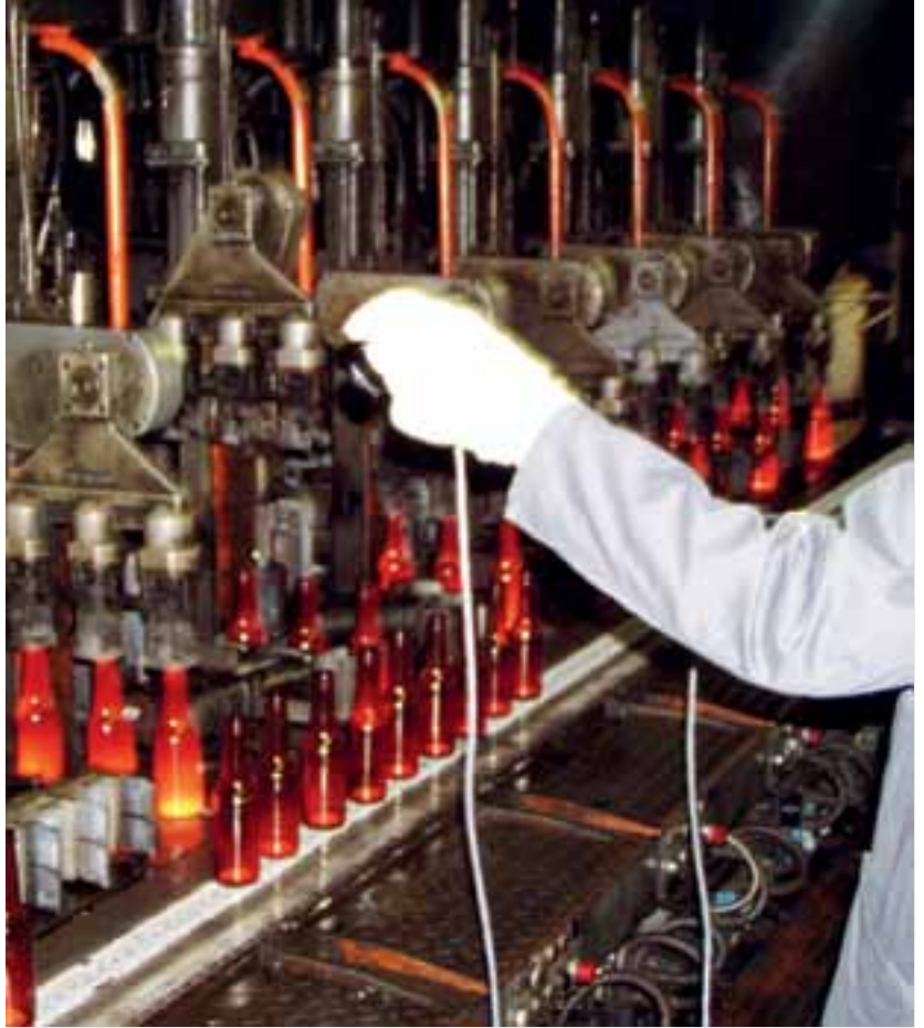
Rotglühende Bierflaschen verlassen die IS-Maschine und geben Infrarotstrahlung ab.
