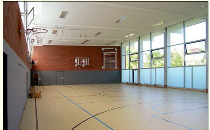
Innen erhielt die Halle einen neuen Belag mit Fußbodenheizung und einen rundumlaufenden Aufprallschutz aus Filz.
