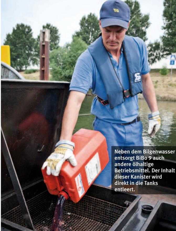
Neben dem Bilgenwasser entsorgt BiBo 9 auch andere ölhaltige Betriebsmittel. Der Inhalt dieser Kanister wird direkt in die Tanks entleert.
