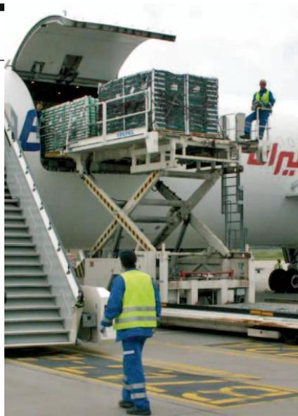
Links: Ein Highloader der neuen Generation. Die teleskopierbare Treppe ist mit einem Geländer gesichert. Oben auf der Plattform befindet sich ebenfalls ein Geländer, das zehn Zentimeter höher ist als bei den alten Geräten.
