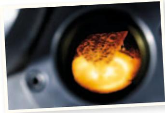
Das Metall Niob wird mehrfach geschmolzen, bevor es weiterverarbeitet wird.
