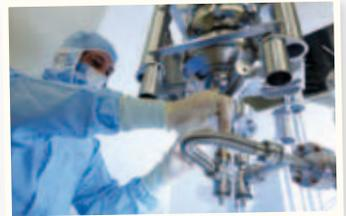
Im Reinraum werden die Beschleuniger-elemente montiert.
