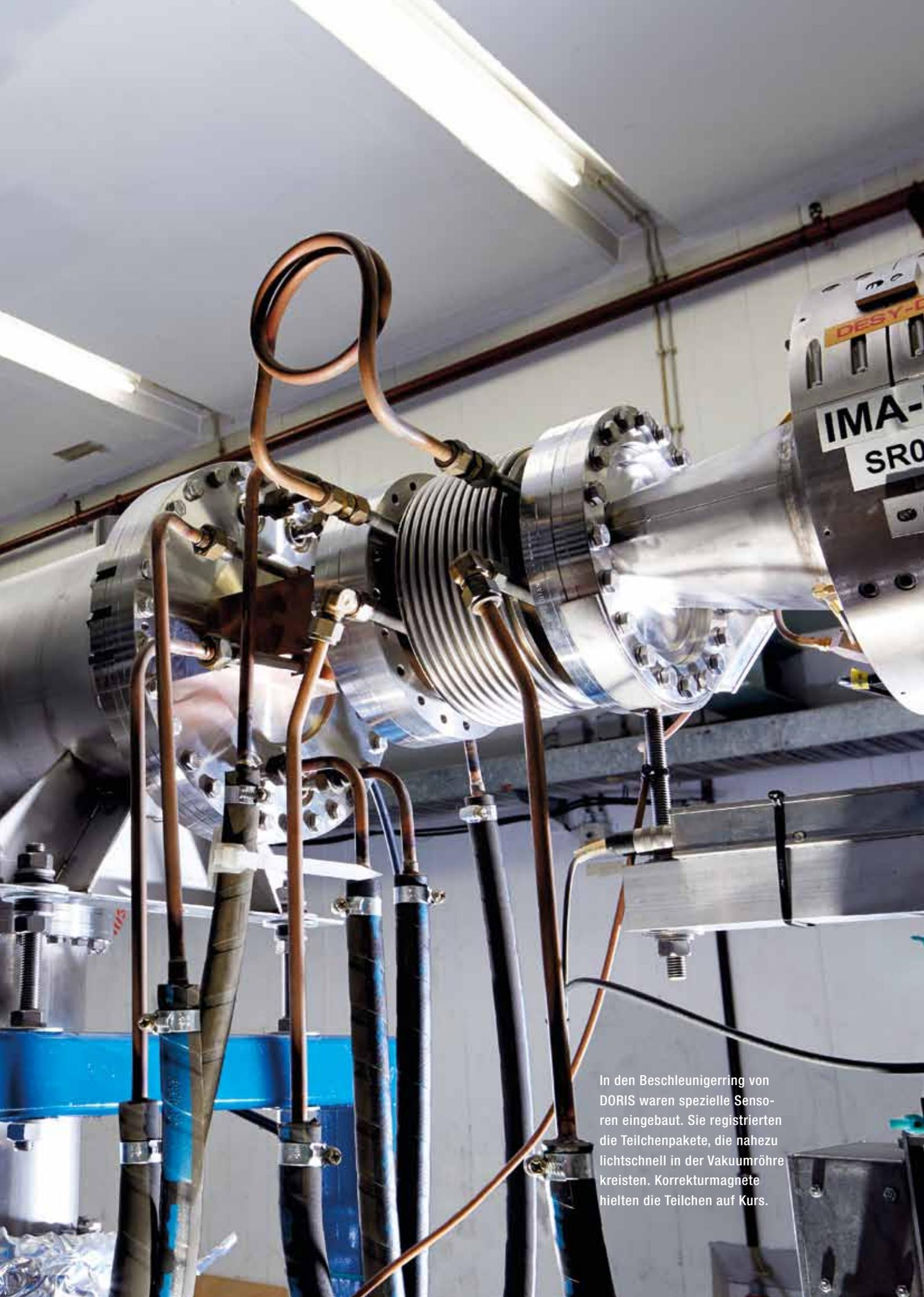
In den Beschleunigerring von DORIS waren spezielle Sensoren eingebaut. Sie registrierten die Teilchenpakete, die nahezu lichtschnell in der Vakuumröhre kreisten. Korrekturmagnete hielten die Teilchen auf Kurs.
