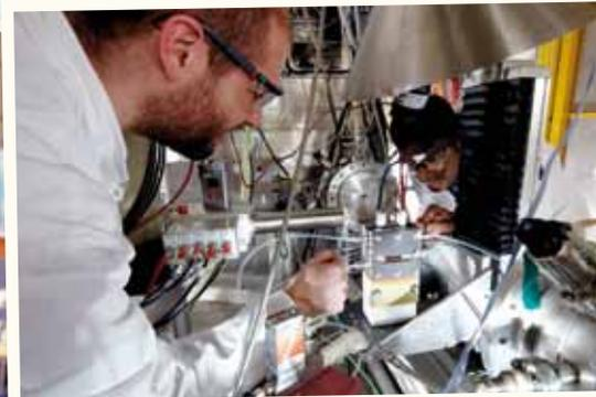
Brennstoffzelle im Synchrotronlicht
