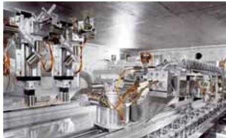
Im Flugzeugbau wird die klassische Verbindungstechnik des Nietens zunehmend durch Schweißverbindungen ersetzt. Für die im Flugzeugbau verwendeten Aluminiumlegierungen eignet sich insbesondere das Reibrührschweißen, das an DORIS optimiert wurde.
