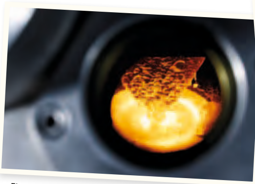
Ein tonnenschwerer Niob-Zylinder muss sechsmal in die Schmelzanlage, bevor er als hochrein gilt und weiterverarbeitet werden kann.
