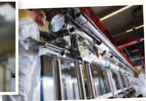
Bevor die Resonatorenkette in das Beschleunigermodul eingesetzt wird, kommen noch andere wichtige Elemente dazu – zum Beispiel Heliumleitungen.
