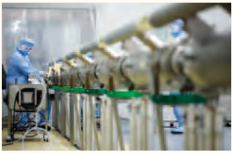
Langsam wird aus den einzelnen Resonatoren eine Kette – insgesamt acht Stück kommen in ein Beschleunigermodul.
