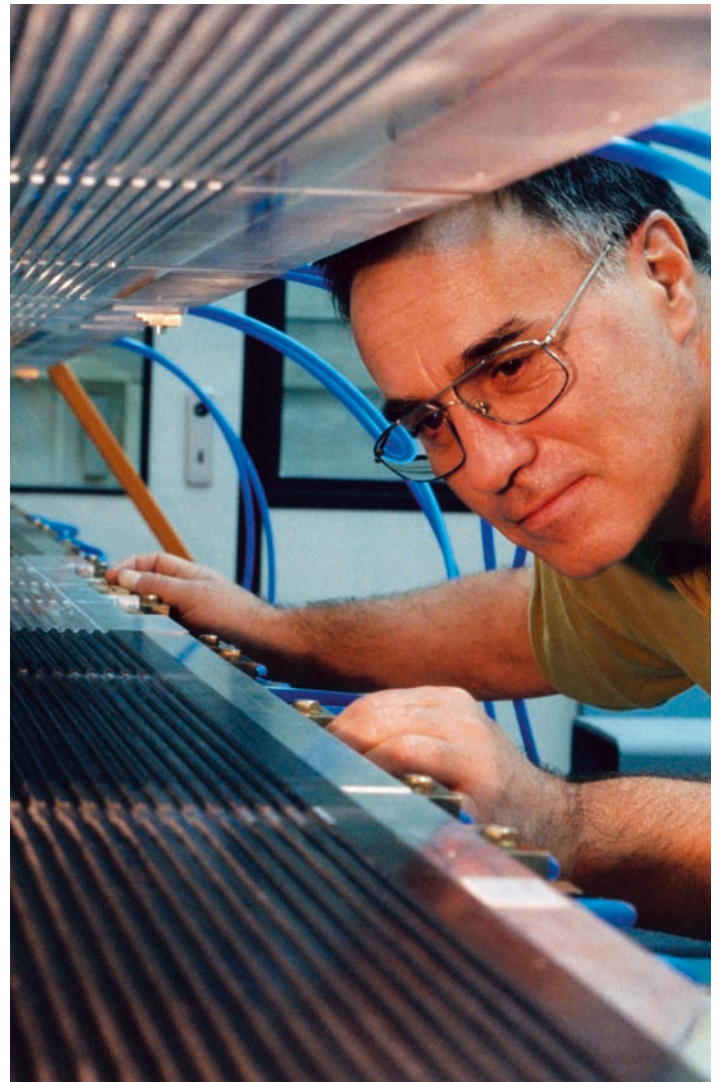
● Bau wichtiger Komponenten für die internationalen Großprojekte, an denen DESY beteiligt ist
