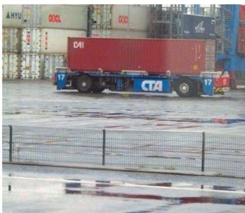
*Selbstfahrende Containerfahrzeuge die über Magnete unter der Teerdecke computergesteuert werden.*
