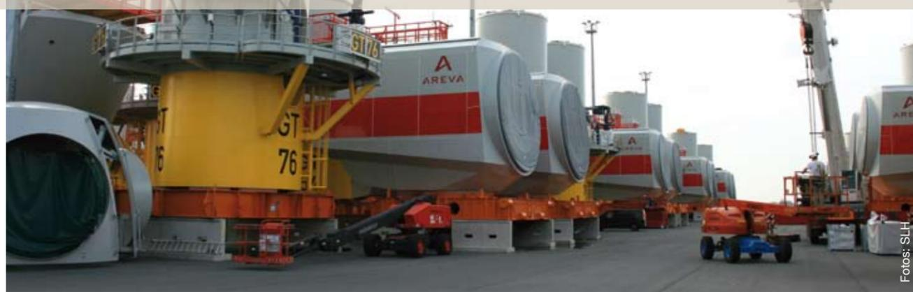
Die Areva-Generatoren werden vor der Verladung noch einmal in einem mehrtägigen Probelauf auf Herz und Nieren getestet
