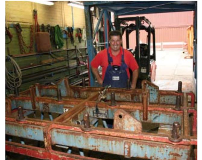
Spezialkonstruktion: So lassen sich gleich sechs Paletten heben
