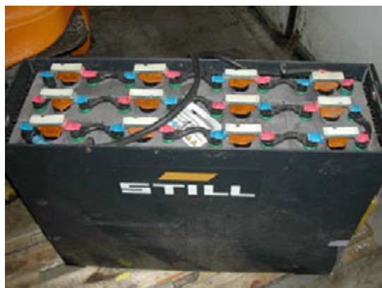
Bild 1: Traktionsbatterie für Gabelstapler mit Versuchssensoren der Klasse 1 [12]
