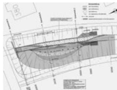
Oben: Geplante Überflutungszonen unter Beibehaltung eines Niedrigwassergerinnes. Deutlich erkennbar ist die sackförmige Aufweitung mit einem Steilufer als Brutplatzangebot für den Eisvogel.
