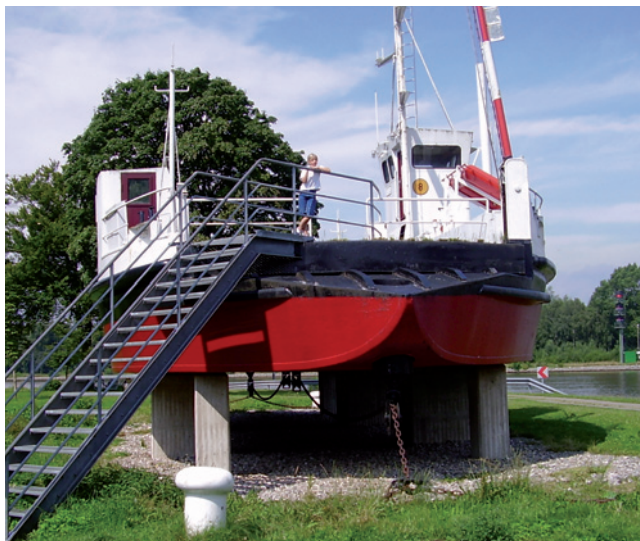
Technik von Gestern, die alte Fähre von Fischerhütte liegt an Land und darf besichtigt werden. Sie fuhr an einer Kette über den Kanal.
