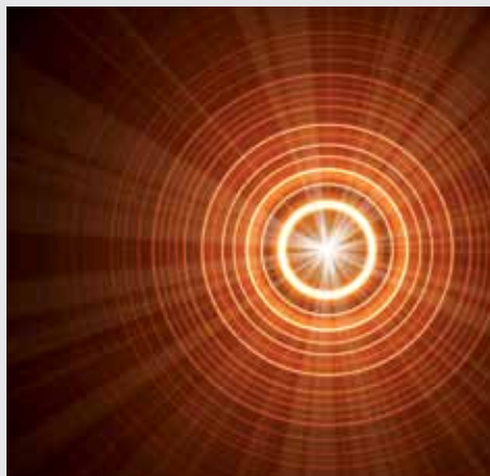
Röntgenstreubild von metallischem Glas. Helle Ringe korrespondieren mit Nanokristallen, breitere und weniger helle mit der amorphen Matrix.
