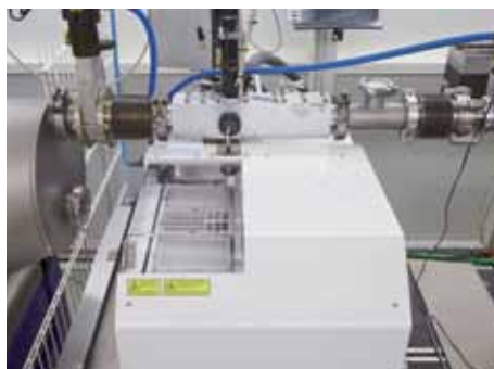
Der vollautomatische Probenwechsler an P12. Bild: EMBL
