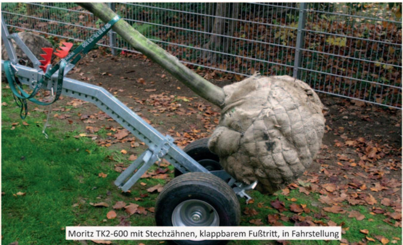
Moritz TK2-600 mit Stechzähnen, klappbarem Fußtritt, in Fahrstellung
