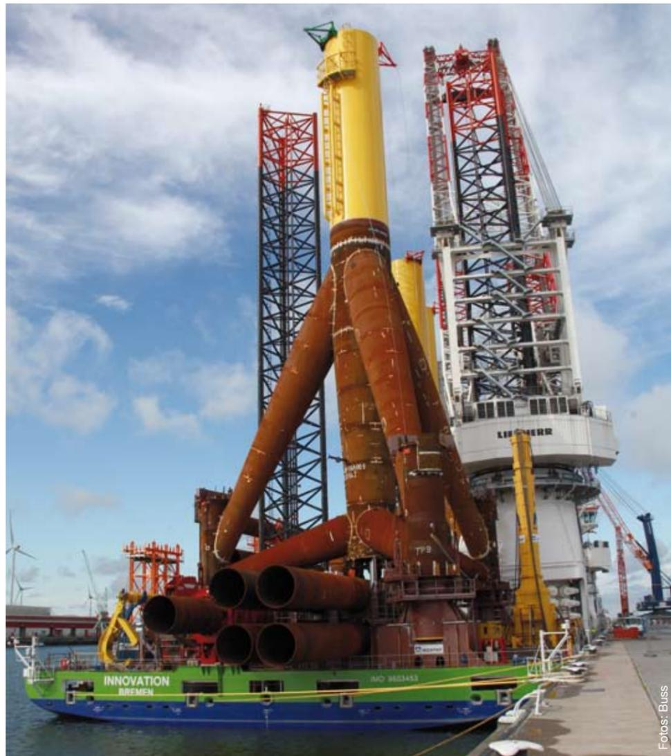
Gründungsfundamente für die Offshore-Windparks werden auf eine Jack-up-Plattform gehoben
