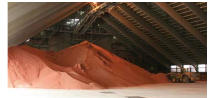
Mit dem Radlader werden die Reste in die Trichter geschoben
