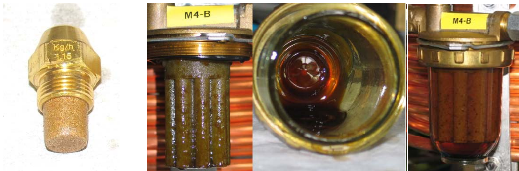
Abbildung 4-23: Ablagerungen im Düsenfilter (kleine hellbraune Kügelchen, welche auf dem Photo schwer zu erkennen sind) und Vorfilter / Filtertasse nach 4000 h Betriebstunden im ATES FAME Lauf bei Einsatz von HEL s-arm mit 20 % FAME
