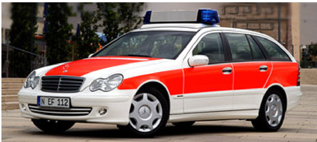
Bild 15: Notarzt-Einsatzfahrzeug auf Basis eines modernen PKW – lackierte Stoßfänger und Fahrtrichtungsanzeiger in den Außenspiegeln führen zu teuren Reparaturen bei Bagatellunfällen [23]
