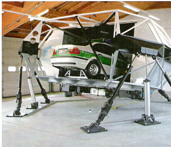
Bild 17: Fahrsimulator der Bayerischen Bereitschaftspolizei. Die Mechanik dient der Nachempfindung von Fahrbewegungen [26]
