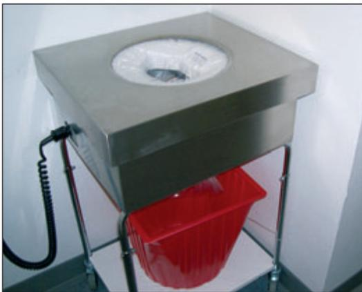
Gerät zum aerosoldichten Einschweißen von zytostatikahaltigen Abfällen in einer Apotheke (Beispiel)
