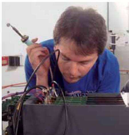
Ingenieur Stephane Callier beim Aufbau des technologischen Prototypen für das Silizium-Wolfram-Kalorimeter für den zukünftigen ILC-Detektor.
