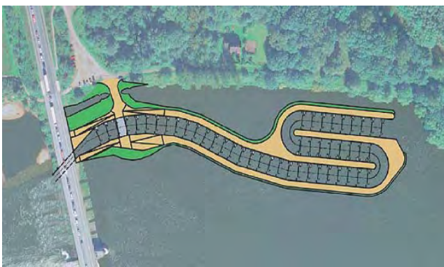
Luftaufnahme der Fischtreppe (Bildmontage)
