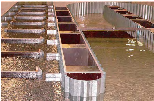
Maßstabsgetreues Modell der Aufstiegs-hilfe (Universität Karlsruhe)
