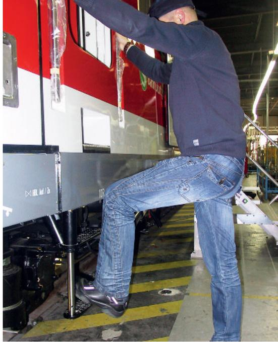
Der absenkbarer Einstiegs- tritt an diesem Triebwagen erleichtert ein sicheres Auf- und Absteigen. Der Hersteller hat besonderen Wert auf Ergonomie und Funktionsfähigkeit bei widrigen Witterungsbedingungen gelegt.
