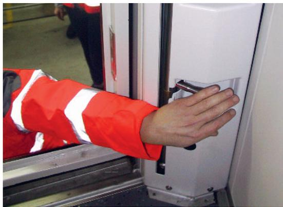
Der Bedienhebel ist sowohl aus dem Führerstand als auch von außen erreichbar.
