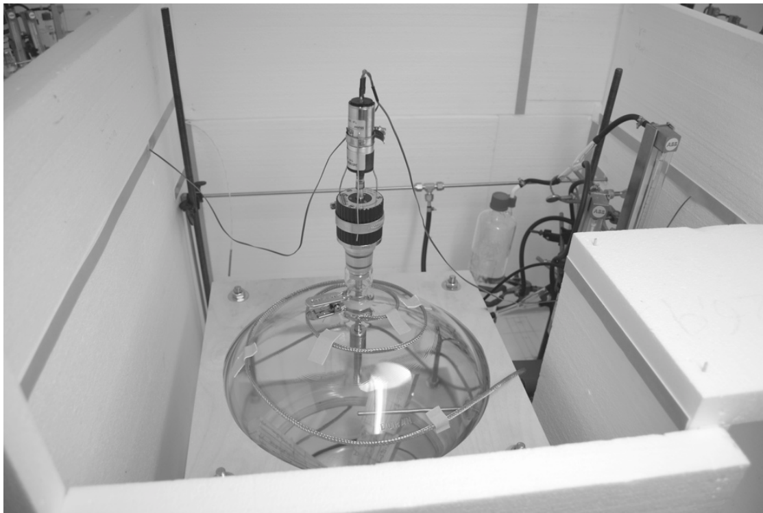
Abbildung 3: Prüfkammer mit Heizband und (teilweise geöffneten) Einhausung
