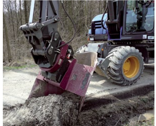
Überall dort, wo Handarbeit eingespart werden muss, bringt der patentierte VarioLöffel® mit seinen zwei unterschiedlichen Öffnungen (V-förmig und rechteckig) - in Verbindung mit Rotation - Höchstleistung. (Foto: Holp GmbH)
