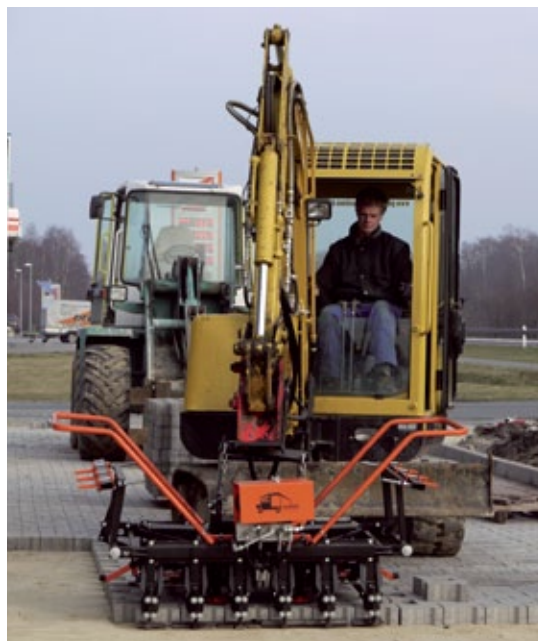
Der Optimas Multi6 Pflastergreifer ist mit sechs Hydraulikzylindern und sechs Greifarmen ausgerüstet. (Foto: Optimas GmbH)
