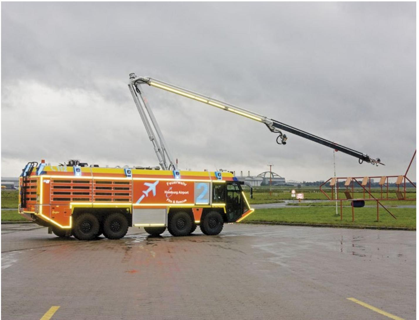
Lösch-Piercing: Mit einem Dorn sticht dieses Fahrzeug in den Flugzeugrumpf, um ein Feuer im Inneren zu löschen.
