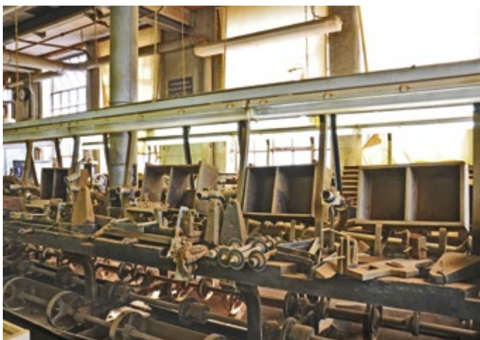
Hier werden die Zähne aus den Kämmen herausgesägt.
