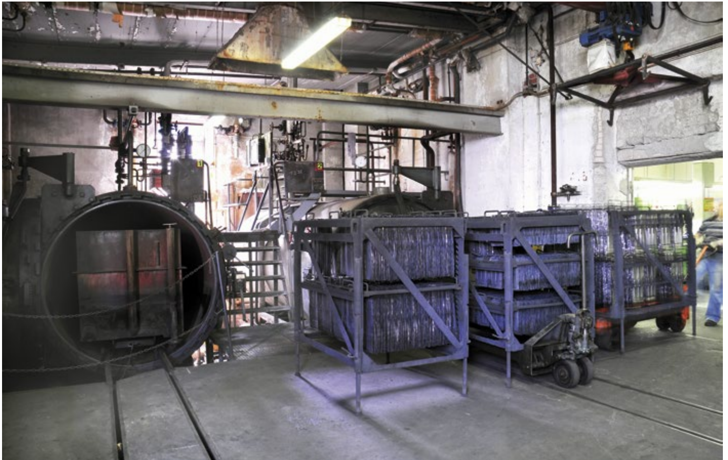
Der zugeschnittene Kautschuk wird zwischen Zinnfolie gepresst und vulkanisiert.
