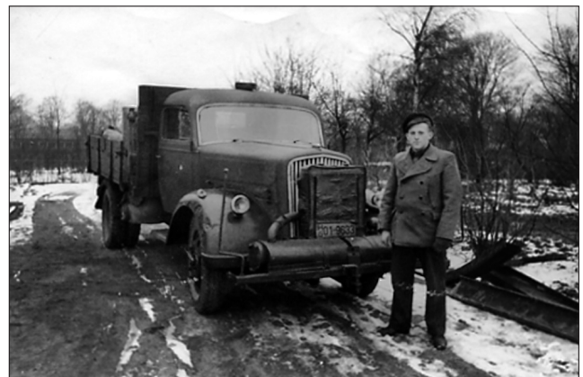
Abbildung 8: Opel-Blitz, von Klaus Jebens für Betrieb auf Holzgasgenerator umgebaut, 1947
