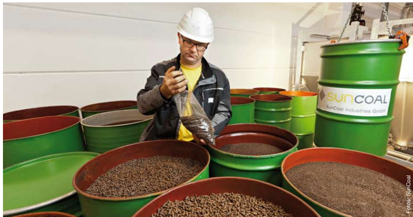
Die Biokohle kann sowohl in Form von Granulat als auch von Pellets oder Briketts produziert werden
