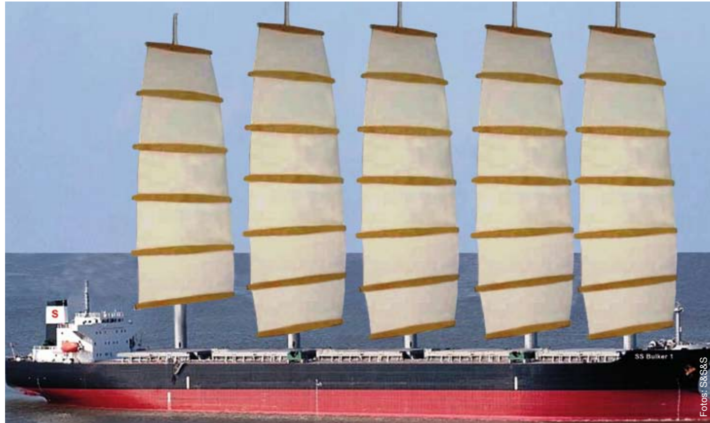
80 Meter hohe Masten, 70.000 Tonnen Ladekapazität, über 20 Knoten schnell: So könnte der Frachtsegler aussehen
